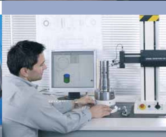
Prüfung mit luftgelagertem Form-Messgerät
