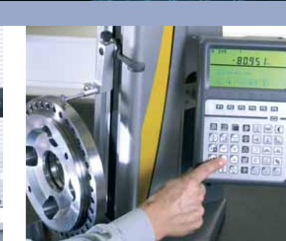
Qualitätskontrolle mit elektronischen Messgeräten
